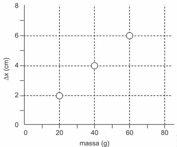
Um astronauta chegou a um planeta desconhecido, e deseja medir a aceleração da gravidade local. Para isso, ele conta com um sistema massa-mola como o da figura 1. Esse sistema foi calibrado na Terra ( $g = 10 \text{ m/s}^2$ ), e a relação entre a distensão da mola e a massa pendurada em sua extremidade é mostrada no gráfico da figura 2.
