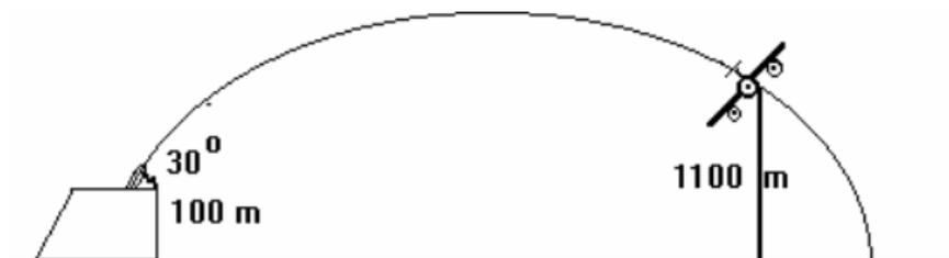
Admitindo  $g = 10 \text{ m/s}^2$ , determine o tempo que o projétil leva para atingir um alvo localizado a 1100 metros de altura, conforme indica a figura. Faça  $\sqrt{3} = 1,7$ .
