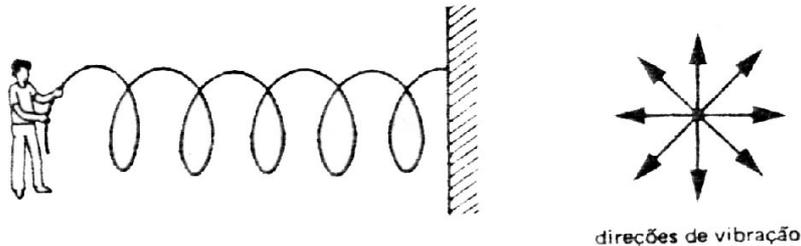
Obtemos neste caso uma onda que vibra em planos diferentes, denominada onda não polarizada ou natural. Neste caso, as partículas da corda vibram em todas as direções perpendiculares à direção de propagação da onda.
