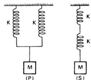
18) Na figura, o corpo de  $1\text{Kg}$  de massa oscila na vertical, em MHS:  $\hat{=}$  Dados  $K_A = K_B = \pi^2\text{N/m}$  e  $K_C = 2\pi^2\text{N/m}$ . Calcule o período de oscilação desse corpo.
