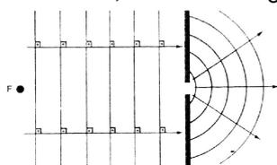
Se a largura da fenda for menor ou igual ao comprimento da onda incidente, ela transpõe o obstáculo. A este fenômeno denomina-se difração.
