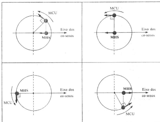
Na figura seguinte, observe-se que, num determinado instante  $t$ , estando a partícula num posto  $P$  da trajetória circular, as projeções ortogonais do vetor raio  $\vec{R}$ , vetor velocidade  $\vec{v}_c$  e vetor aceleração centrípeta  $\vec{a}_{cp}$  do MCU correspondem, nesse mesmo instante, respectivamente, à posição  $\vec{x}$ , velocidade  $\vec{v}$ , e aceleração  $\vec{\gamma}$  da partícula projetada, que efetua um MHS no eixo dos co-senos (que coincide com o eixo  $x$ ).
