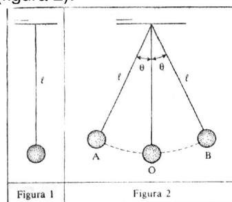
O movimento pendular é periódico. O ângulo  $\theta$  é denominado **amplitude** do pêndulo. Esse ângulo é formado pelo alongamento máximo do fio com a vertical que passa pelo ponto de suspensão. Para pequenas amplitudes ( $\theta \cong 50$ ), o período de oscilação é expresso por:
