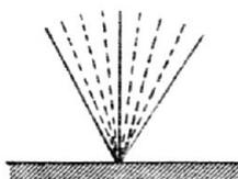
Quando deslocamos a lâmina, sua extremidade livre começa a oscilar para a direita e para esquerda.
