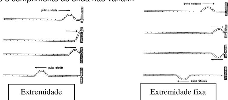
O pulso na corda com a extremidade livre é refletido com a mesma fase do pulso incidente. Já o pulso na corda com a extremidade fixa é refletido com a fase invertida. Portanto estará defasado  $\pi$  rad.
