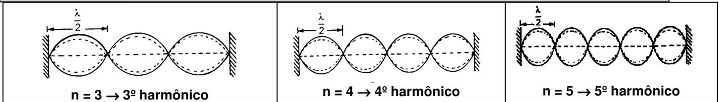
Observe nas figuras acima que o comprimento  $L$  da corda e o comprimento de onda  $\lambda$  são tais que:
