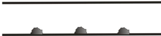
A conclusão em que se chega é que são formadas ondas estacionárias dentro do tubo. Em regiões de grandes vibrações o pó vai se espalhando e se acumulando nas regiões que não vibram, identificando aí os pontos onde ocorrem as interferências destrutivas das ondas, ou seja, os nós. Então representamos simbolicamente as ondas formadas nos tubos das seguintes maneiras:
